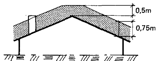
Figur 36:43 Ventilationsskorstens höjd över tak vid självdragsventilation.
